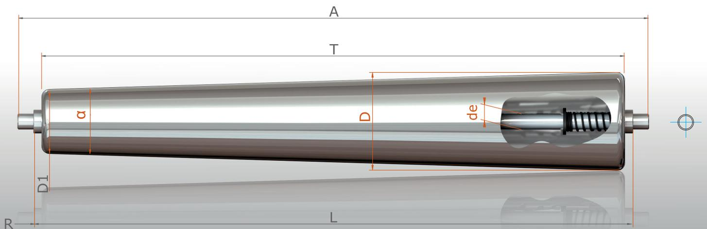
RULLI CONICI FOLLI LCF - LCF TAPER IDLER ROLLERS
