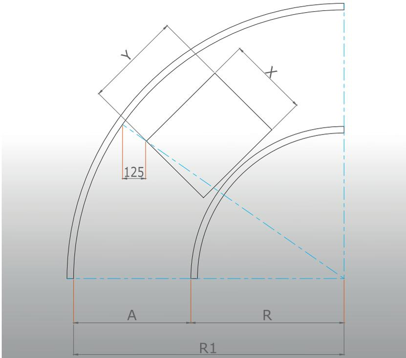
Le rulliere curve motorizzate possono essere realizzate con rulli cilindrici o rulli conici. A lato è riportato lo schema per la costruzione di una rulliera curva motorizzata a 90 gradi. La lunghezza dei rulli va determinata tenendo conto della larghezza e lunghezza del materiale trasportato. il raggio di una curva è misurato sul lato interno.
